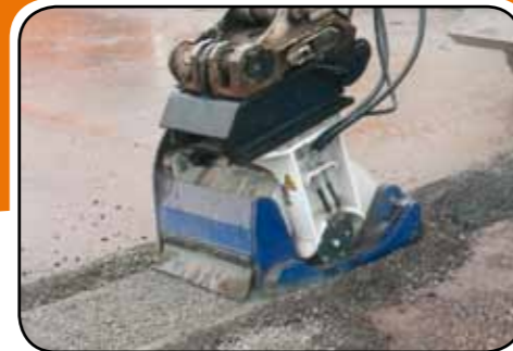
Die Fräsbreite der Maschinen reicht von 30 bis zu 60 Zentimeter und die Frästiefen von 0 bis max. 19 Zentimeter bei der EX 60 bzw. EX 60 HD.
